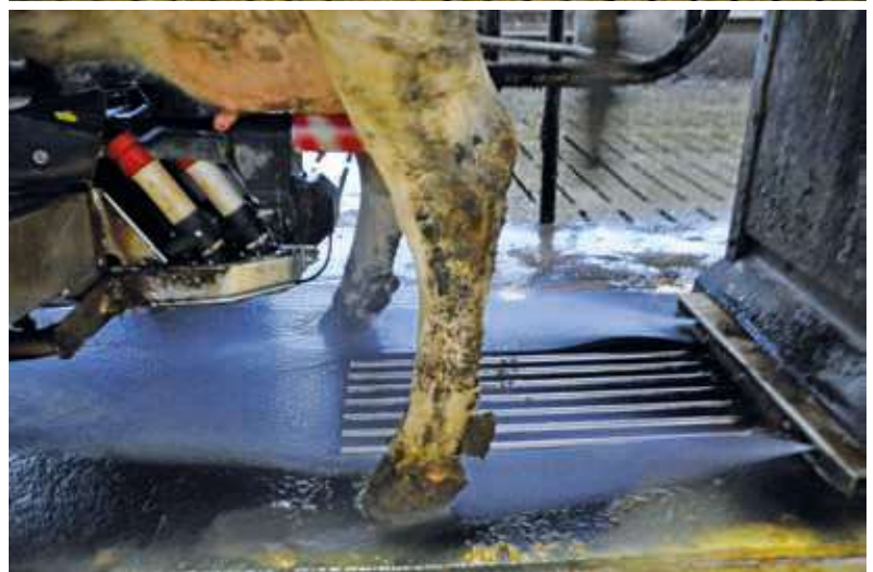
Les stalles des robots sont équipées de buses de désinfection pour les pattes.
