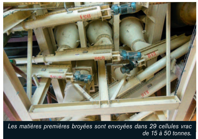
Les matières premières sont pré-broyées après réception, et le broyeur autorégule sa vitesse pour une qualité optimum de broyage.
